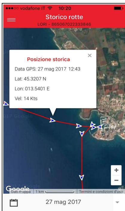
L'immagine può essere ingrandita per vedere in dettaglio una porzione della rotta o rimpicciolita per visualizzare la rotta completa
